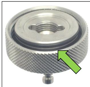
Am Gasanschluss ist der O-Ring auf Risse hin zu kontrollieren. Zum leichteren Aufschrauben kann der O-Ring von außen mit etwas Vaseline bestrichen werden.
