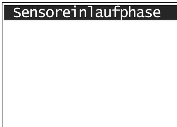
Nach der Auswahl dieses Menüpunktes beginnt die Sensoreinlaufphase. Sie dauert nur ~ 25 Sekunden und sollte immer in frischer Umgebungsluft erfolgen. Die Sensoreinlaufphase wird auch durch den blinkenden Hinweis „Sensoreinlaufphase“ in der obersten Zeile des Displays angezeigt.
