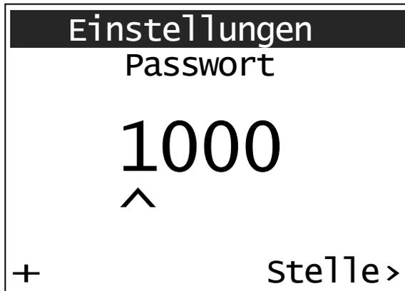
Im Menüpunkt Einstellungen kann der Anwender einige Anpassungen des Gerätes vornehmen. Dazu muss erst einmal das Passwort eingegeben werden. Mit **F1** (+) wird die angezeigte Stelle inkrementiert (0-9) und mit **F2** (Stelle>) kann die nächste Stelle ausgewählt werden. Durch die Taste „Menu“ wird das Passwort bestätigt. Die Voreinstellung des Passwortes ist <1000> und kann mit einer speziellen Software geändert werden.
