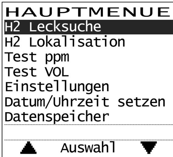
Aus dem Hauptmenü heraus können die einzelnen Menüpunkte ausgewählt werden. Mit den Funktionstasten **F1** und **F2** wird die Auswahl des gewünschten Menüpunktes getroffen. Der Menüpunkt ist dabei durch eine Markierung hervorgehoben.
