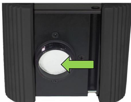
Beim Einsetzen des Filters ist darauf zu achten, dass dieser mittig in der Kammer liegt, damit kein Gas am Filter vorbeiströmen kann. Die glänzende, strukturierte Seite des Filters zeigt dabei nach innen und die glatte Seite nach außen.
