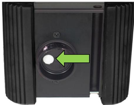
Bei abgeschraubtem Anschluss können, nachdem die Filterscheibe entfernt wurde, der O-Ring und der integrierte Staubfilter kontrolliert werden. Sollte der O-Ring beschädigt sein, muss dieser getauscht werden, um eine einwandfreie Funktion des Messgerätes zu gewährleisten.
