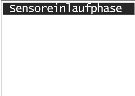
Nach der Auswahl dieses Menüpunktes folgt die Sensoreinlaufphase. Sie dauert nur ~30 Sekunden und sollte immer in frischer Umgebungsluft erfolgen. Die Sensoreinlaufphase wird auch durch den blinkenden Hinweis „Sensoreinlaufphase“ in der obersten Zeile des Displays angezeigt.
