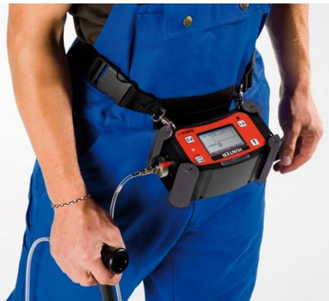
Das HUNTER H<sub>2</sub> wird mit einem speziellen Tragesystem vor dem Körper, im Sichtfeld des Bedieners, getragen. Es kann an den Ösen des HUNTER H<sub>2</sub> befestigt werden. Das Tragesystem hält das Gerät sehr sicher und schwankungsfrei im direkten Sichtfeld des Anwenders.
