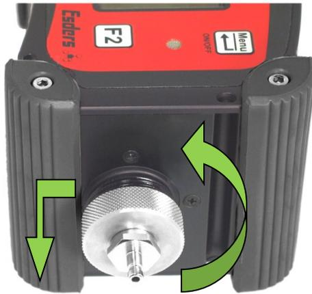
Um den hydrophoben Filter zu tauschen, muss der Anschluss vom **HUNTER H<sub>2</sub>** heruntergeschraubt werden. Durch Linksdrehung an der Rändelschraube drückt sich der Anschluss automatisch ab und kann dann durch Zug nach vorne vom Gerät getrennt werden.
